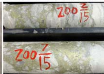
照片 4 ZK304 脉状浸染状黄铜矿石
