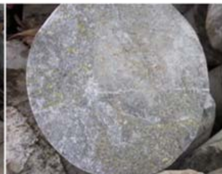
照片 2 ZK304 浸染状斑铜—黄铜矿石
