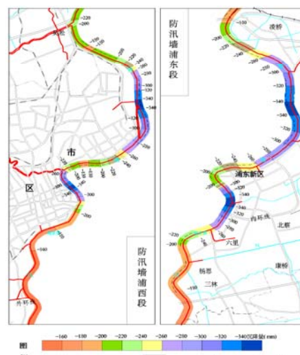
上海地面沉降对防汛墙沉降监测
