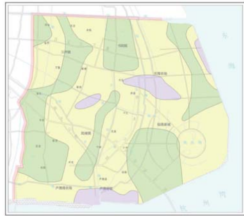
图 一、分区 不液化区 轻微液化区 中等液化区 例 二、其它 分区界线 工作区界线
