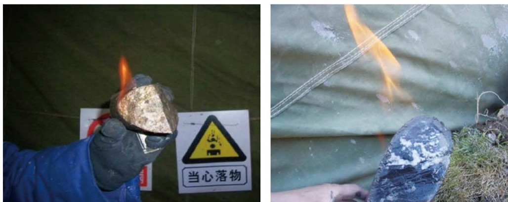
图4 祁连山木里地区钻获的天然气水合物样品(左)及点火燃烧(右)
