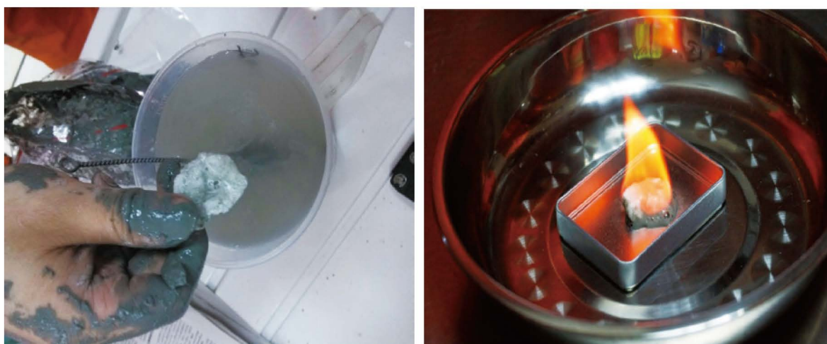
图8 利用大型重力活塞获取的天然气水合物样品（左）及点火燃烧（右）
