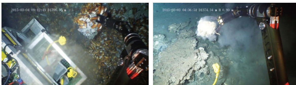
图7 “海马”号在“冷泉”区获取生物样品（左）和碳酸盐结壳样品（右）
